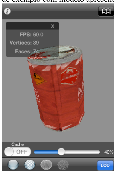
Figura 17 - Tela de exemplo com modelo apresentando 40% dos vértices originais
