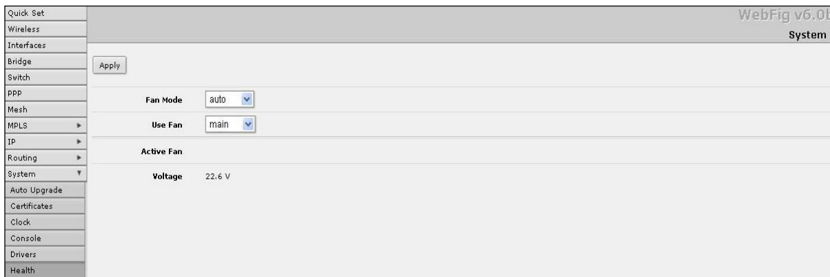
Figura 11 - Monitoramento da tensão da bateria de uma RouterBoard, através da Webfig
