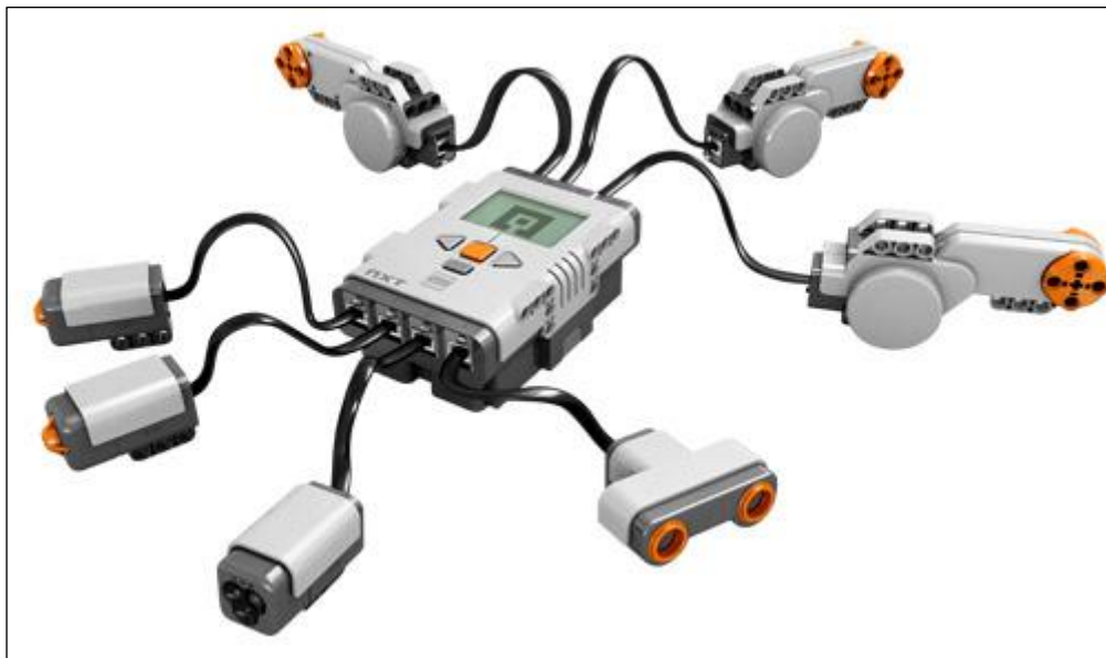
Figura 1 - Bloco programável NXT conectado a todos os motores e sensores
