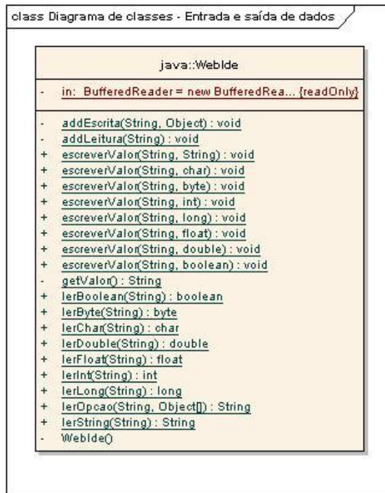
Figura 19 - Classe utilizada para entrada e saída de dados durante a execução e depuração
