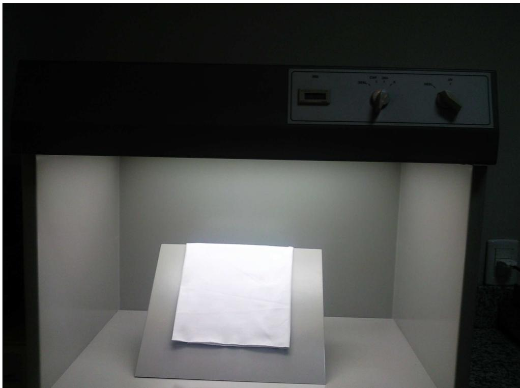
Figura 4 – Cabine de luz simulando iluminante D65
