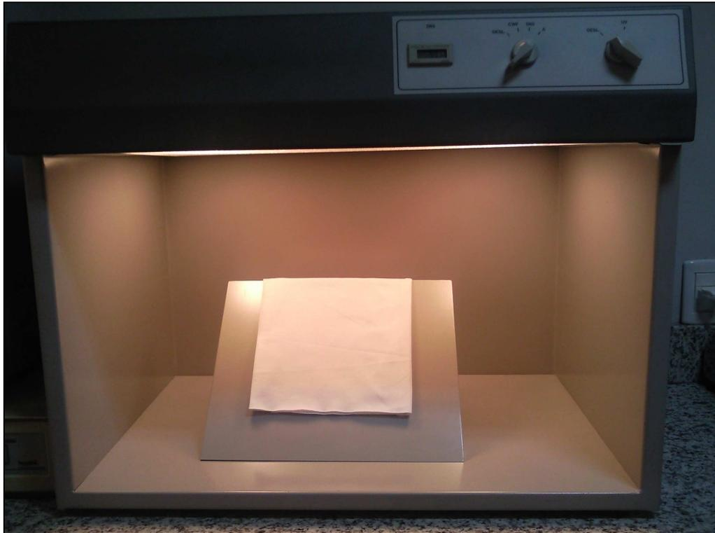
Figura 3 – Cabine de luz simulando iluminante A
