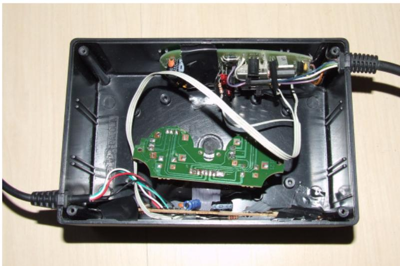
Figura 18 – Adaptação de *joystick* USB ao assento massageador Car Massager
