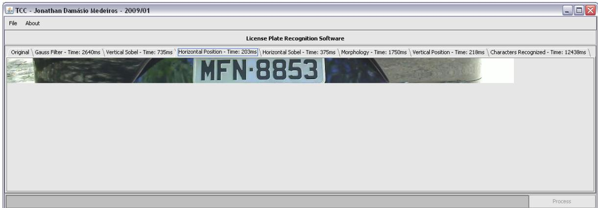
Figura 30 – Resultado localização horizontal da placa do veículo
