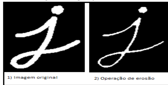
Figura 6 - Operação de erosão
