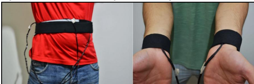
Figura 4 - Cinta e simulador de bengalas dessentidos para o Blind Counter-Strike
