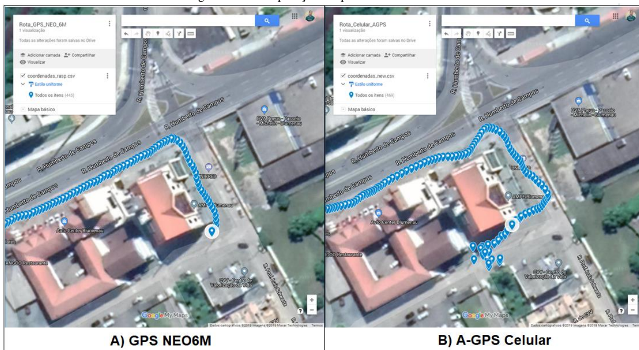
Figura 16 – Comparação de precisão GPS e A-GPS
