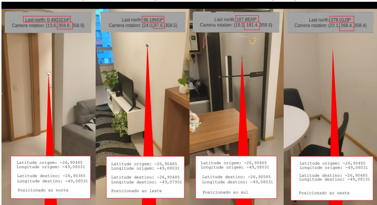
Figura 13 – Testes feitos para avaliar a eficiência da bússola e giroscópio
