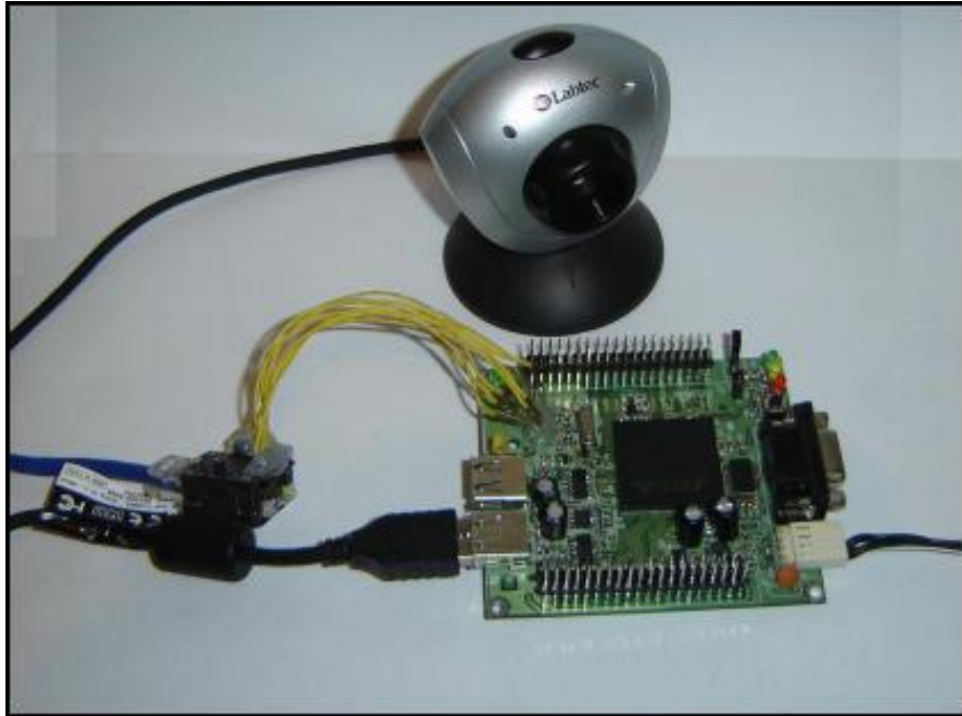
Figura 6 - Conexão de dispositivos a Fox Board
