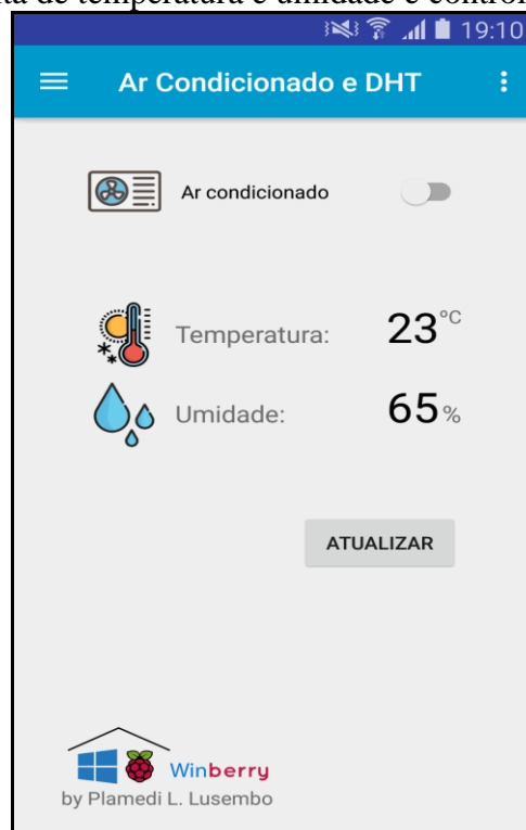
Figura 44 – Consulta de temperatura e umidade e controle do ar condicionado
