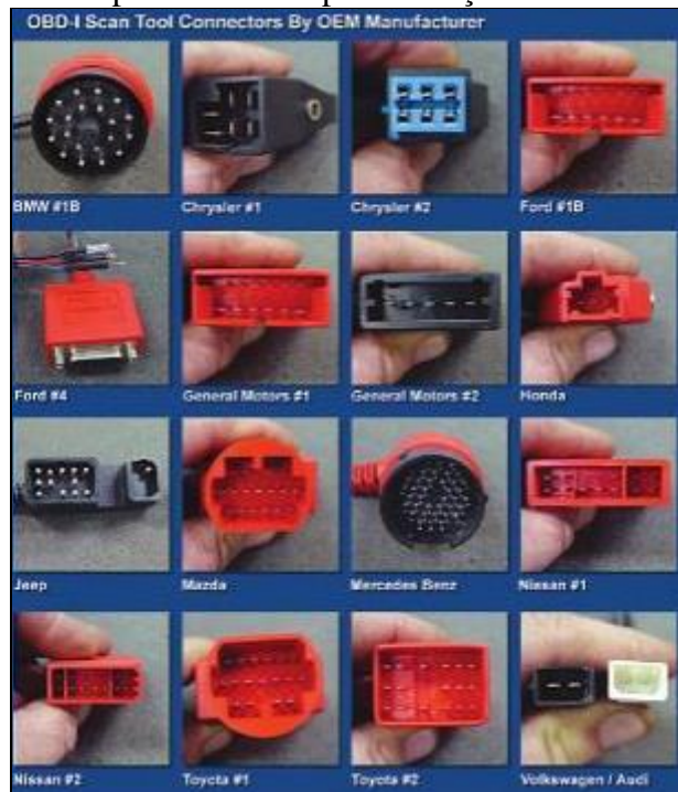
Figura 3 - Exemplo de falta de padronização de conectores OBD-I
