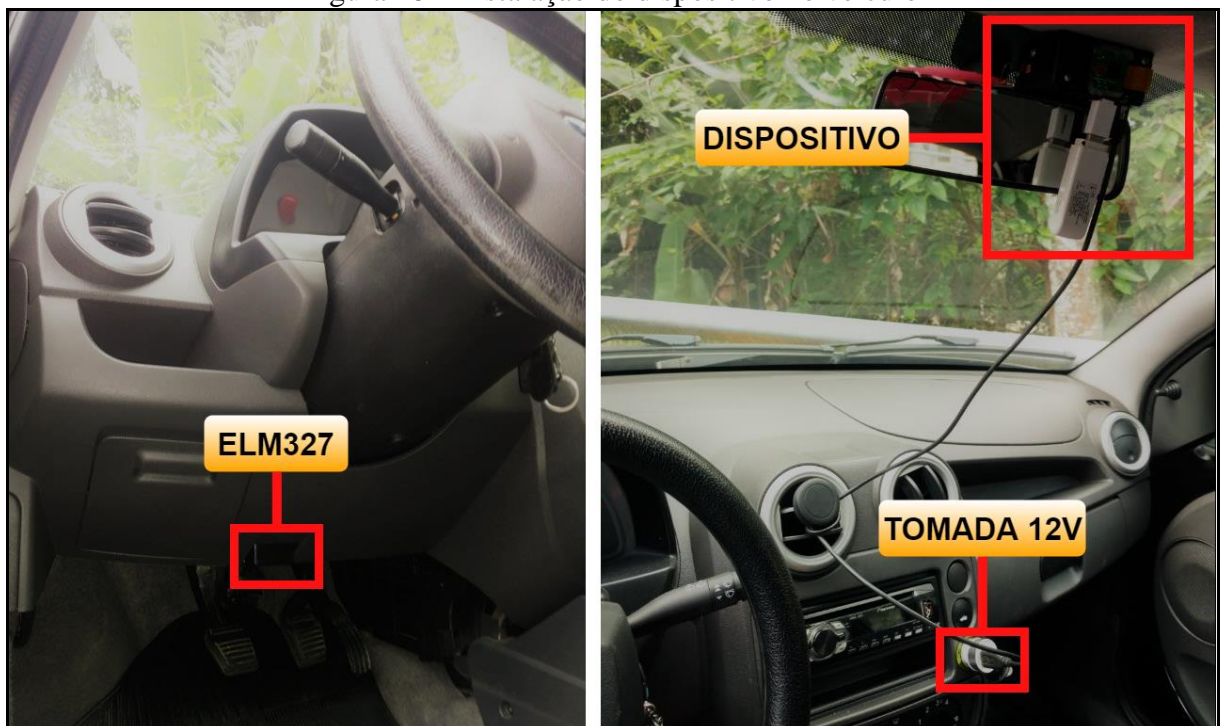
Figura 28 – Instalação do dispositivo no veículo
