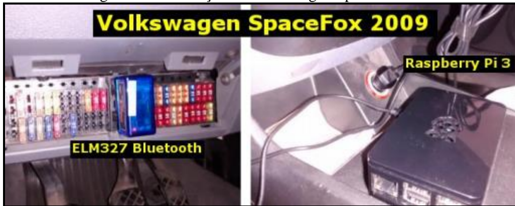
Figura 14 - Instalação no Volkswagen SpaceFox 2009
