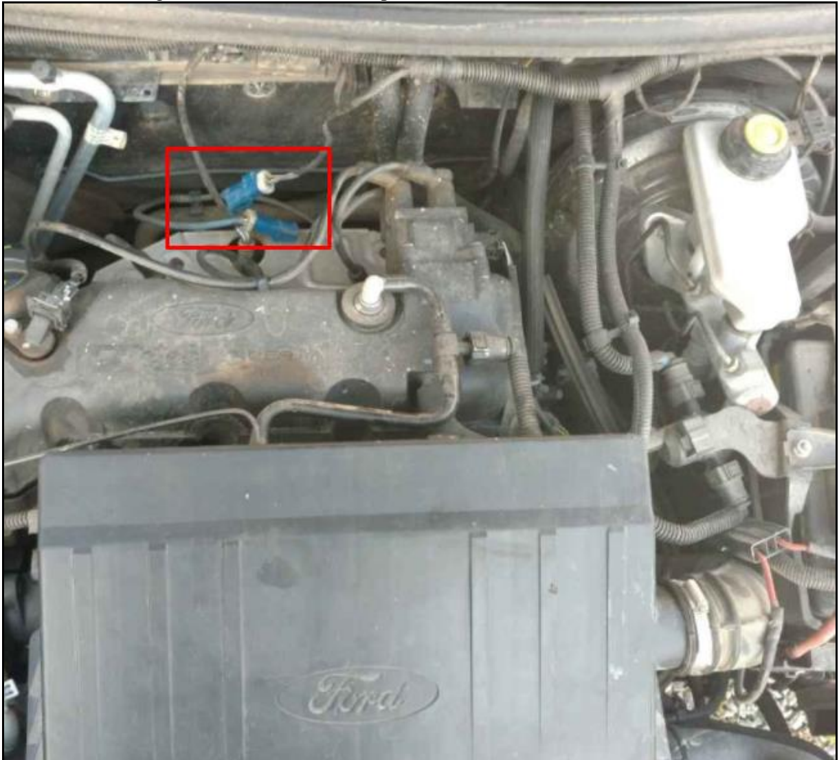
Figura 37 - Cabo do sensor para a sonda Lambda desconectado.
