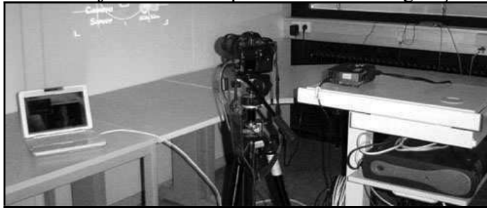
Figura 20 - Projetor e câmera para realizar a triangulação óptica
