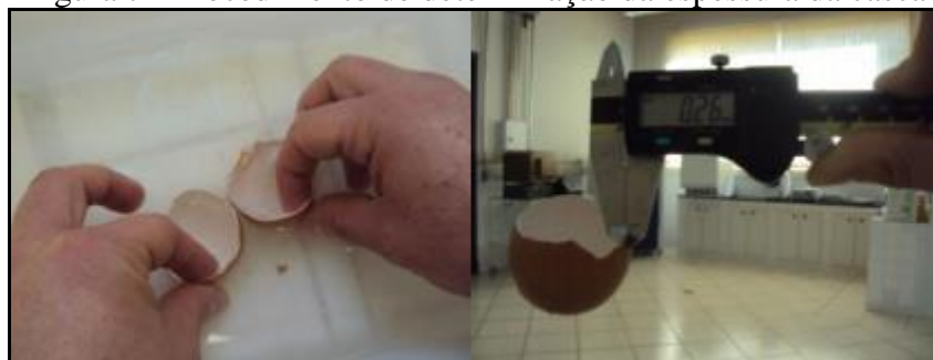
Figura 7 - Procedimento de determinação da espessura da casca
