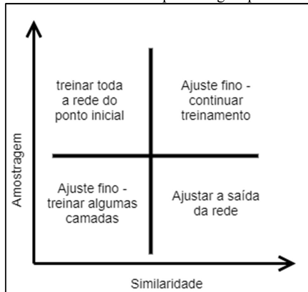
Figura 37 – Diagrama de transferência de aprendizagem para redes neurais profundas
