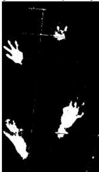
Para limpar os ruídos internos, foi aplicada a operação morfológica de abertura, que é caracterizada pela aplicação da operação de erosão seguida de uma dilatação. Ambas utilizando o mesmo elemento estruturante. O Quadro 18 mostra o trecho de código responsável pela operação de abertura onde, utilizou-se o método `cvErode` sobre a imagem resultante da subtração anterior e, posteriormente o método `cvDilate` sobre a imagem erodida.
