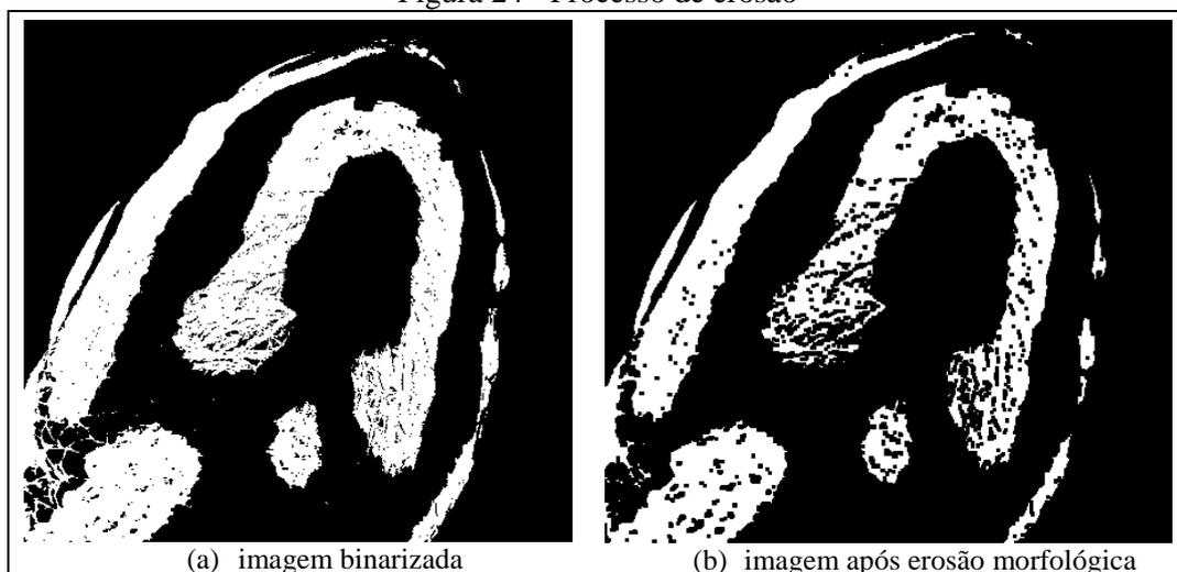
Após a remoção de pixels dispersos por meio da operação de erosão, é aplicado o filtro de dilatação. Esta operação é responsável pelo preenchimento de pequenos buracos dos objetos.
