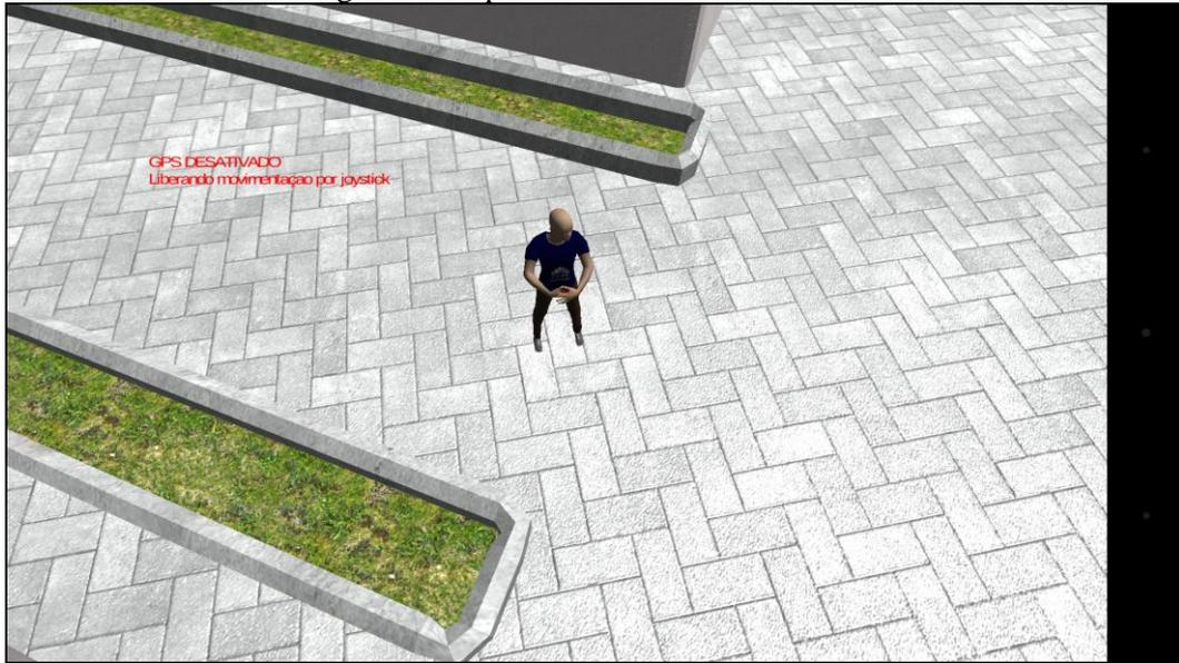
A Figura 48 demonstra o aplicativo em execução com o GPS ativado. Ao habilitar o GPS, ainda pode ocorrer um *delay* (tempo de espera) até o aplicativo desabilitar a movimentação pelo *touch* e habilitar a movimentação pelo GPS. Este *delay* pode ocorrer, pois, o hardware do GPS do dispositivo ainda não enviou as coordenadas para o aplicativo, ou ainda está sendo iniciado. Caso ocorra algum erro ao obter as coordenadas pelo GPS, o aplicativo irá habilitar o *touch*.
