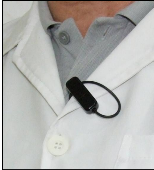
Figura 28 - Utilização do microfone do smartphone para a captura dos dados do sono
