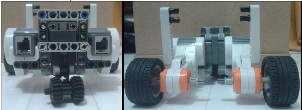
Após montar a roda livre, é necessário criar a estrutura que é utilizada como referência para posicionar o robô no cenário. Esta estrutura também é parte da base de apoio do celular e seu detalhamento pode ser acompanhado na Figura 27. Na Figura 28 é possível verificar o resultado desta estrutura acoplada ao que já foi montado do robô e ao bloco programável.
