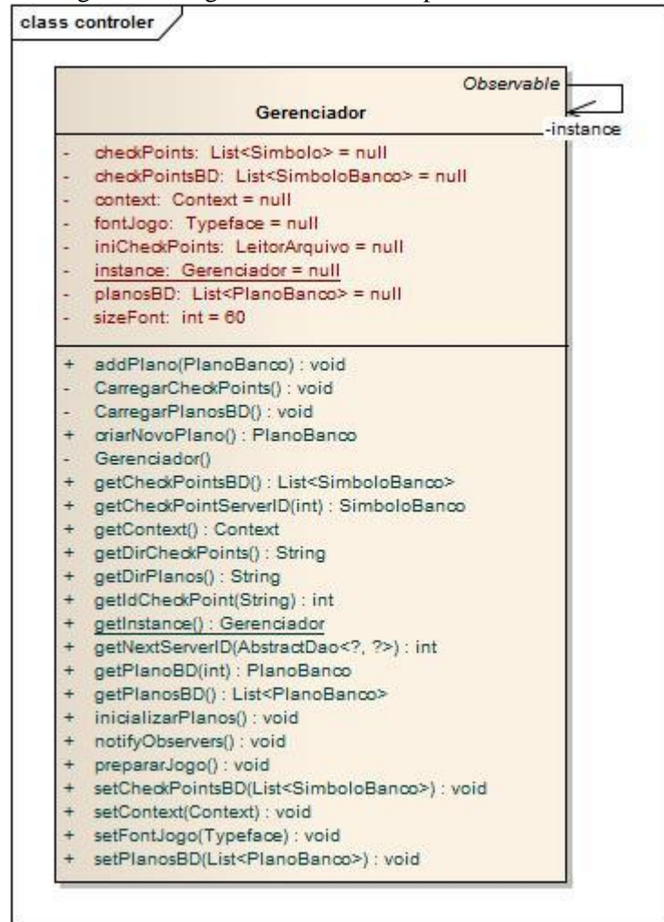
Figura 6 - Diagrama de classes do pacote controller
