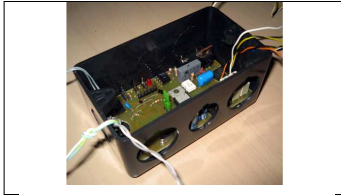
Figura 38 – Placa acionadora dentro da caixa elétrica
