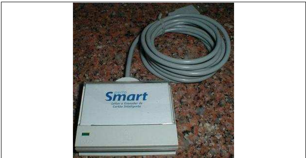
Figura 15 – Leitor e gravador de smart cards utilizado para testes
