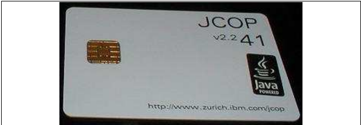
Figura 14 – Smart card utilizado para testes ( JCOP tools smart card )
