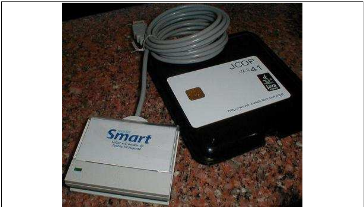
Figura 16 – Kit smart card + CAD utilizado para testes com JCOP Shell
