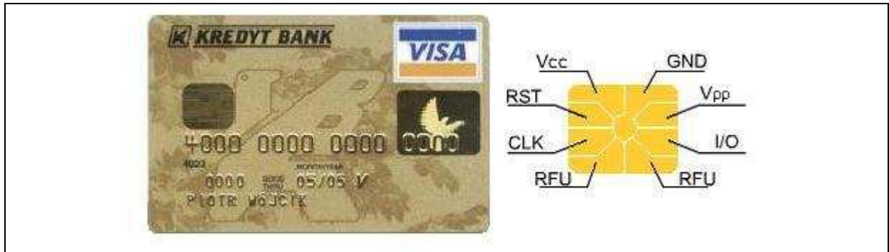
Figura 1 – Exemplo de smart card e a disposição dos contatos no chip
