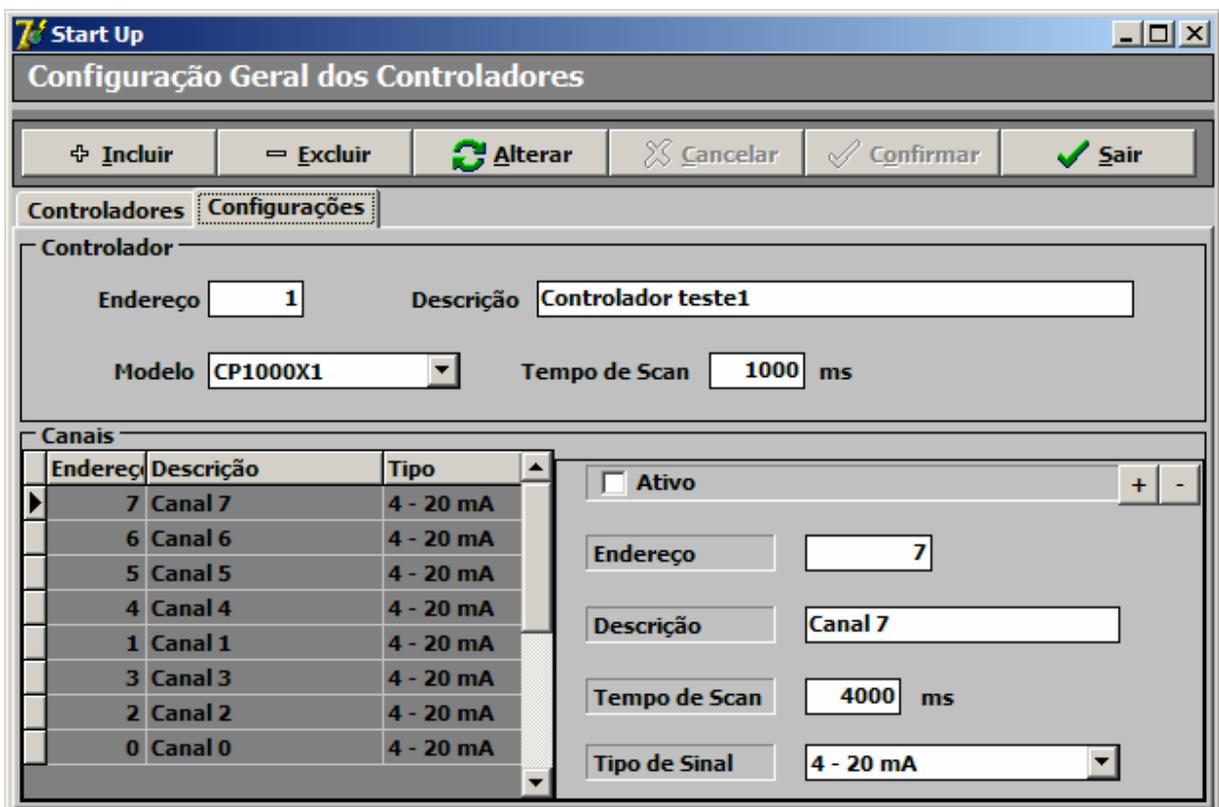
Figura 54 – Interface de configuração dos controladores(configuração dos canais)
