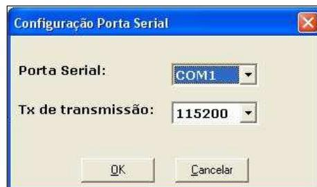
Figura 15 – Janela de configuração da comunicação com o CLP
