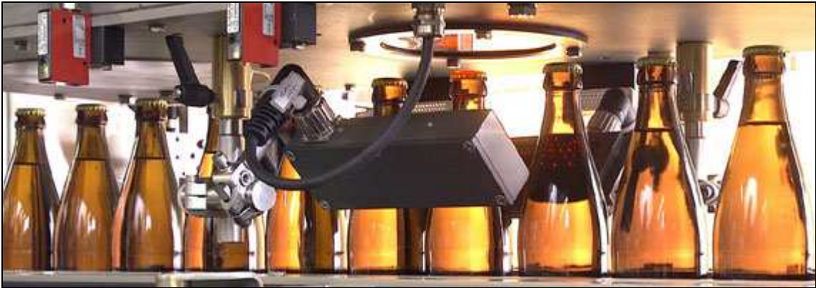
Figura 3 – Exemplo sistema de inspeção automatizada
