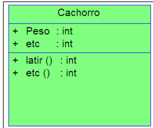
Figura 1: Exemplo de representação de uma classe utilizando a UML (Diagrama de classes)
