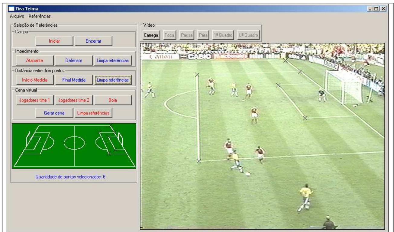
Figura 19 – Pontos de referência para a calibração da câmera
