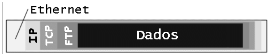
FIGURA 3 – Exemplo de envio de dados através do protocolo FTP
