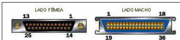
Cada um dos 25 pinos do conector DB25, tem uma função distinta, assim como os 36 pinos do Centronics 36, conforme Figura 2.
