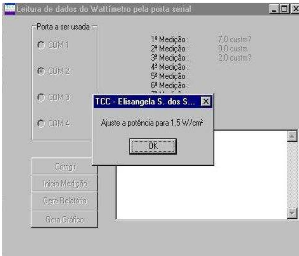
Na tela de leitura de dados do wattímetro pela porta serial, demonstrada na fig. 5.4, o operador define a porta serial que será usada, se o operador informar a porta serial disponível em seu computador, o botão Corrigir fica inibido, caso contrário se a porta for informada errada pelo operador o *software* mostrará uma mensagem de erro e habilitará o botão Corrigir para que o operador possa informar a porta correta.
