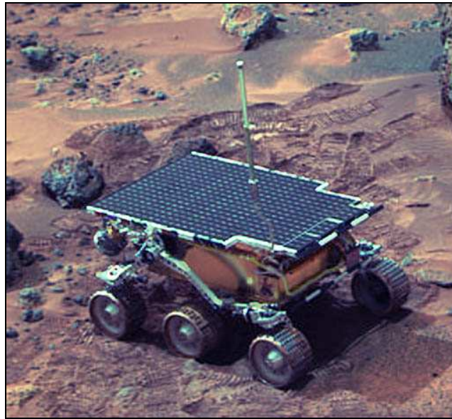
Figura 31: Veículo Sojourner em solo Marciano.
