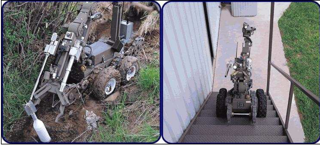
Figura 34: Andros Mark V-A1 robô para desativação de bombas.
