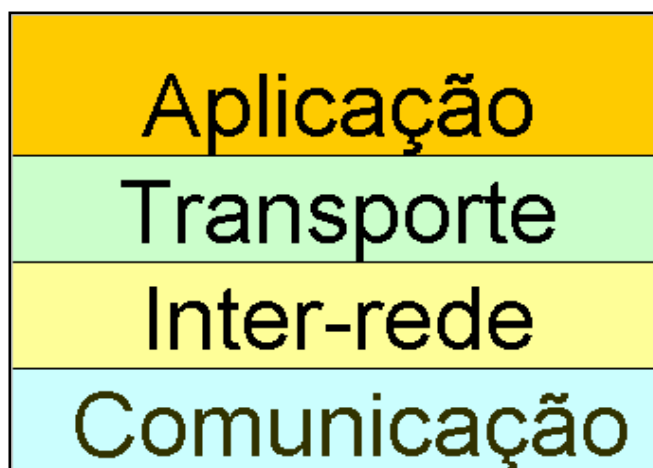
FIGURA 2.2 - MODELO EM CAMADAS DA INTERNET
