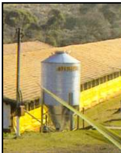
FIGURA 08 – MODELO DE SILO COM DISTRIBUIÇÃO AUTOMÁTICA DE RAÇÃO
