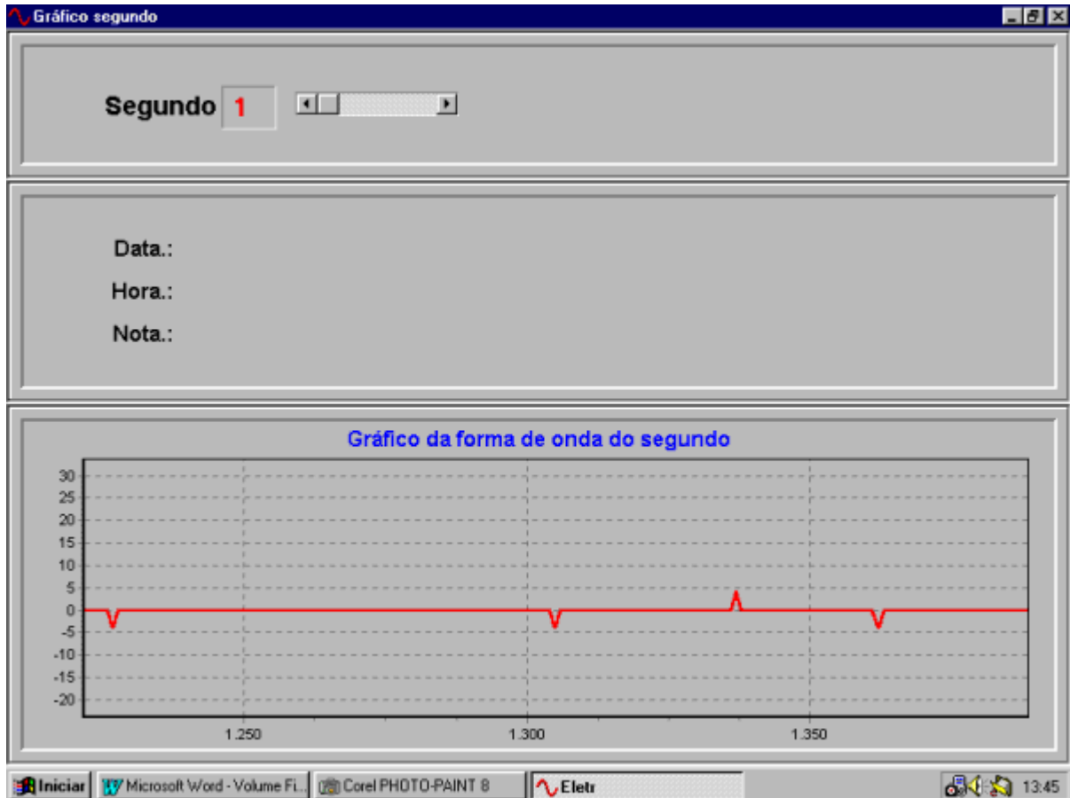
FIGURA 26 - OSCILAÇÃO NO BIT MENOS SIGNIFICATIVO DO ADC
