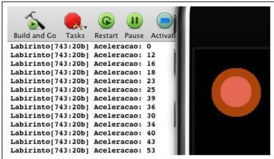
Componente joystick retornando a aceleração via console
