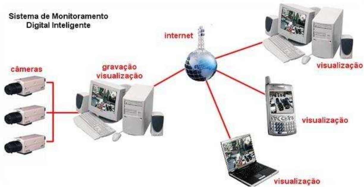
Estrutura básica de um sistema de CFTV
