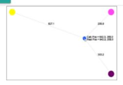
O teste de trilateração verifica se a equação retorna os valores x, y esperados. A função dist() do p5.js é utilizada para calcular a distância entre os vértices e a posição do mouse.
